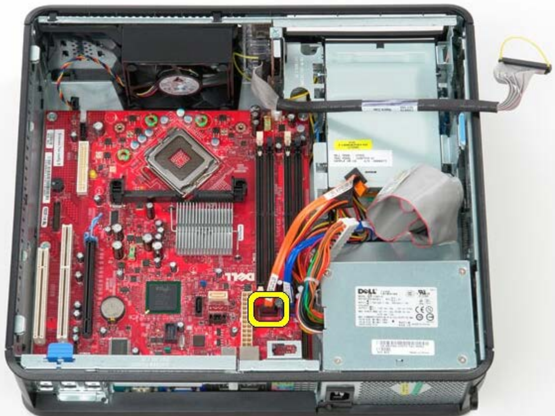
10. Frakobl datakablet til harddisken fra systemkortet.
