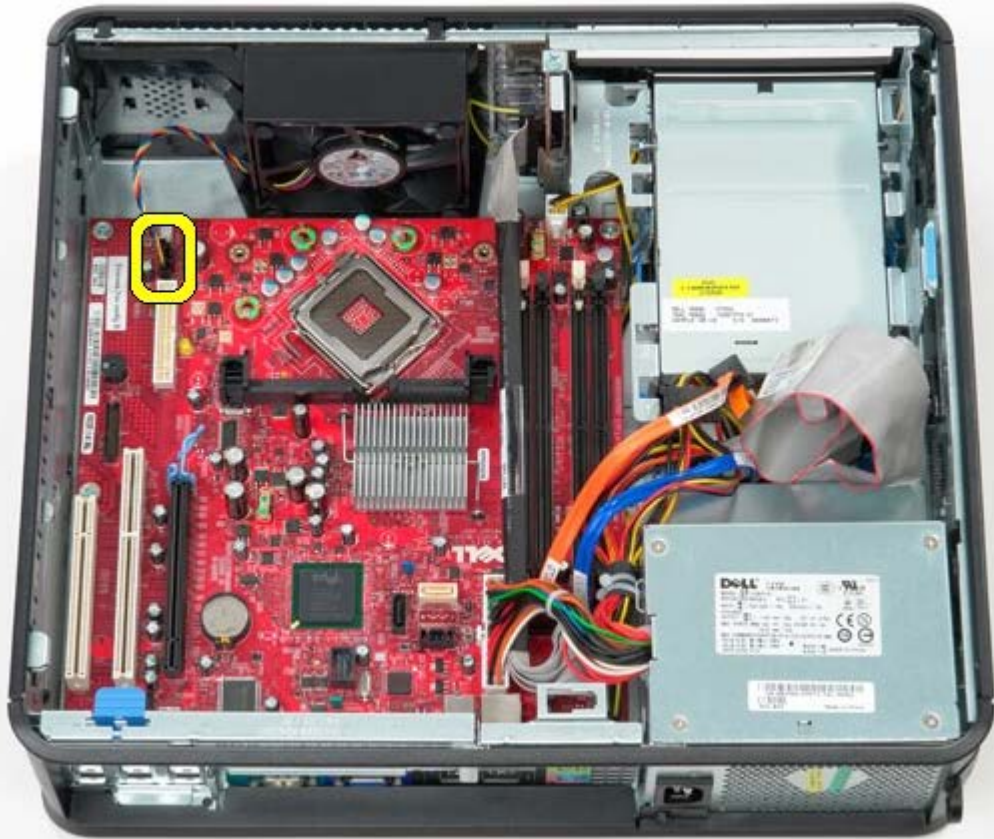
7. Frakobl hovedstrømkablet fra systemkortet.
