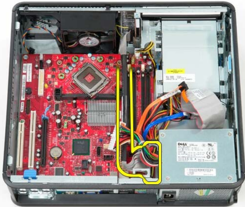
9. Frakobl datakablet til det optiskedrev fra systemkortet.
